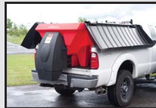
Couvert en polyéthylène Cover in polyethylene
